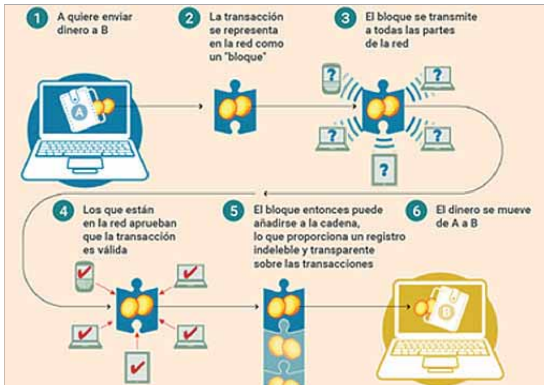
Figura 8. Ejemplo de funcionamiento de Blockchain. Fuente: Financial Times.
